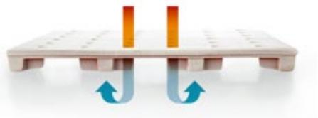
Climatile proporciona todas as vantagens térmicas de uma cobertura ventilada e sombreada - a relação entre o diâmetro dos furos e a espessura assegura que a entrada dos raios solares através da área vazada é desprezível.
